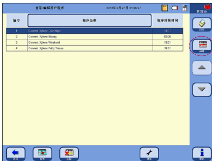
最多 20 个程序，每个程序最多可定义 12 个试剂步骤和 3 个浸蜡步骤。
