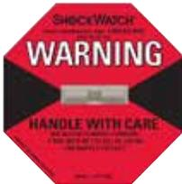
在 Shockwatch 系统中，有一个精密玻璃管，可以红色色调图显示超过指定强度的冲击或撞击。超过规定的加速 (g 值) 将破坏玻璃管内部液体的表面张力。这将导致指示管改变颜色。
