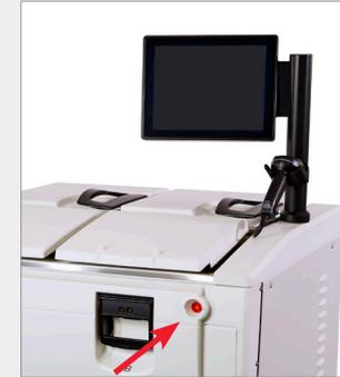
Espere a que la pantalla se quede en blanco y, a continuación, pulse el **botón de encendido** situado en la parte delantera del instrumento.
