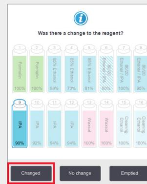
Seleccione la botella que ha sustituido pulsándola en la pantalla. Pulse **Changed** (Cambiada).
