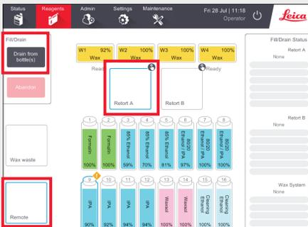
Accedere a Reagents > Remote Fill/ Drain (Reagenti > Riempimento/Scarico a distanza).
