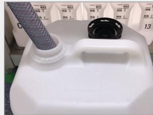
Inserire il tubo in un contenitore stabile con capacità sufficiente per evitare il traboccamento,
