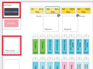
Accedere a Reagents > Remote Fill/ Drain (Reagenti > Riempimento/Scarico a distanza). Toccare **Wax waste (Scarico paraffina)** e le camere della paraffina da svuotare, quindi toccare **Drain To Waste (Scarica)**.
