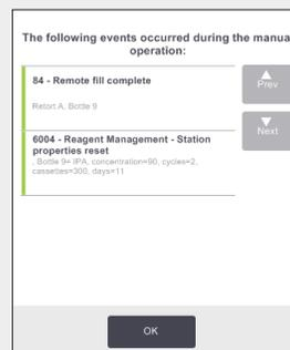
Una volta completato il riempimento, viene visualizzato un riquadro di coda azioni.
