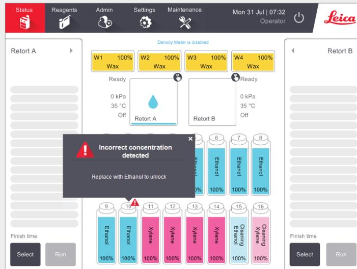
PELORIS 3 dispone di due misuratori di densità, uno per ogni camera di processazione. Solo i reagenti con etanolo (compreso etanolo di grado reagente e miscele IPA-etanolo), IPA e xilene vengono controllati dai misuratori di densità. I fissativi, i reagenti di pulizia e i sostituti dei reagenti (come Histolene) non vengono controllati. I reagenti controllati sono descritti in dettaglio nel manuale d'uso di HistoCore PELORIS 3 (situato sotto il simbolo Leica nella barra delle funzioni).
