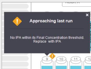
Sostituire il reagente quando i flaconi appaiono tratteggiati nella schermata **Status (Stato)**.
