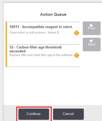
La finestra **Action Queue (Coda azioni)** avvisa riguardo ad azioni obbligatorie o consigliate prima dell'esecuzione del protocollo. Assicurarsi di prendere nota del messaggio, in quanto include anche la procedura da eseguire per ogni codice numerico.
