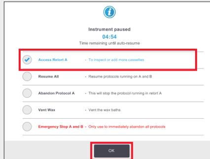
Nella finestra di dialogo **Instrument paused (Strumento in pausa)**, toccare **Access Retort (Accedi alla camera di processazione)**. Un segno di spunta blu viene visualizzato accanto all'opzione toccata. Toccare **OK**.
