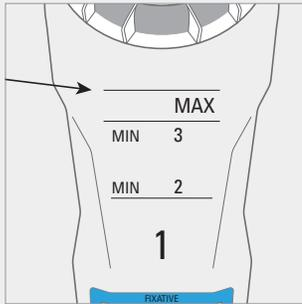
Rabboccare/riempire il flacone quando il reagente è sotto il livello minimo, MIN 2 per la configurazione a 2 cestelli e MIN 3 per la configurazione a 3 cestelli.
