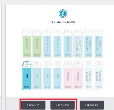
Per l'esempio mostrato, utilizzare l'opzione **100% IPA** a meno che non sia necessario modificare la concentrazione, in tal caso utilizzare **Edit % IPA (Modifica % IPA)** utilizzando il tastierino. Toccare **OK** al termine.
