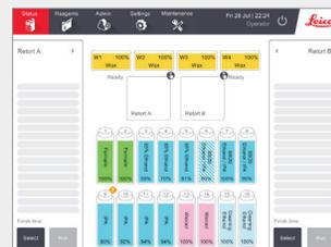
Sostituire il reagente quando i flaconi appaiono tratteggiati nella schermata **Status (Stato)**.
