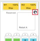
Tippen Sie auf das Retorten-Scan-Symbol für die Retorte, die für den Programmlauf verwendet werden soll. Dies öffnet das Dialogfeld Retort Baskets (Retortenkörbe).
