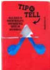
Indicatore Tip-n-Tell per monitorare se il prodotto sia stato trasportato e stoccato in posizione verticale conformemente ai requisiti richiesti. Con una pendenza di 60° o più, la sabbia in quarzo blu fluisce nella finestra indicatrice a forma di freccia e vi aderisce in modo permanente. Una movimentazione errata della spedizione è rilevabile immediatamente e può essere comprovata in modo definitivo.
