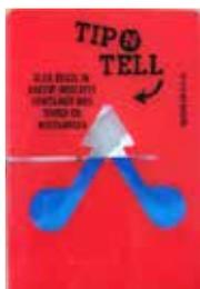
O indicador Tip-n-Tell monitora se a remessa foi transportada e armazenada na posição vertical, de acordo com suas demandas. Com uma inclinação de 60° ou mais, a areia de quartzo azul desliza até a janela indicadora em formato de seta e permanece ali permanentemente. O manuseio incorreto da encomenda é imediatamente detectável e pode ser definitivamente comprovado.
