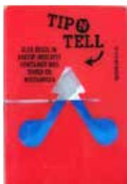
横積み・転倒（Tip-n-Tell）インジケータが、お客様の要件に従って積荷が立てた状態で搬送および保管されているかどうかを監視します。60° 以上傾くと、青いケイ砂が矢形のインジケータウィンドウに流れ込んでそこにとどまります。積荷の不適切な取り扱いがあった場合、即座に検出され、確実に証明することができます。
