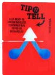
**Título del símbolo:**Indicador Tip-n-Tell para controlar si el envío ha sido transportado y almacenado en posición vertical según sus requisitos. A partir de una inclinación de  $60^{\circ}$ , la arena de cuarzo azul fluye hacia la zona de indicación con forma de flecha y permanece adherida. El manejo incorrecto del envío se detecta inmediatamente a simple vista y es perfectamente comprobable.
