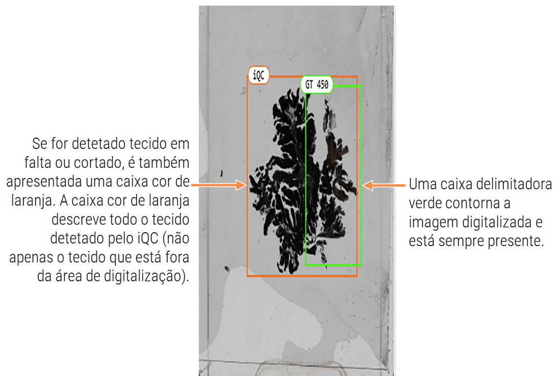
Figura 4-2: Caixas delimitadoras de tecido em falta e cortado.
