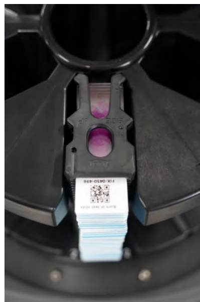
Abbildung 6-20: Rack ist vollständig ins Karussell eingelegt:
