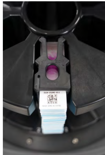
Abbildung 6-10: Rack vollständig in den Rack-Steckplatz eingelegt:
