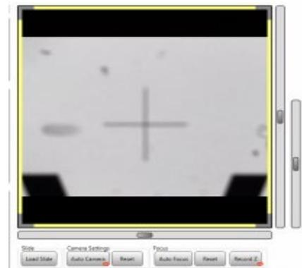
La configurazione ottimale della fotocamera durante la scansione viene determinata automaticamente durante la mappa di messa a fuoco e non è consigliabile regolare di routine la visualizzazione dell'immagine live (dal vivo) in un modello.
