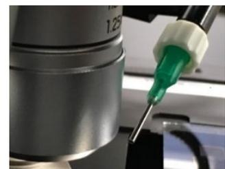
**Nota:** se si utilizza una lente PlanApo 20x con il sistema, verificare che la punta del dispositivo di deposizione olio sia libera da essa anche durante la rotazione della torretta.
