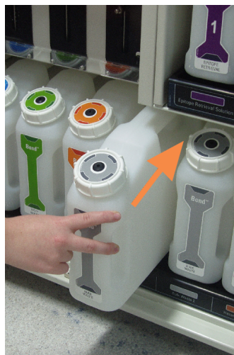
Cyret 12-1: Επανατοποθέτηση του δοχείου αποβλήτων στη θέση του
