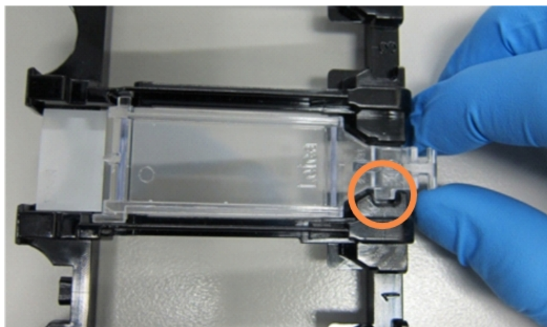
Cyret 4-6: Τοποθέτηση ενός Covertile σε πλακίδιο
