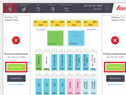
Seguire le indicazioni per scaricare le camere di processo e rimuovere le cassette. Al termine, chiudere le camere di processo e avviare la pulizia rapida. Inserire il nome utente quando richiesto.
