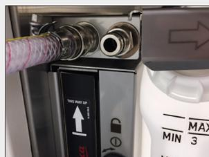
Collegare il tubo per il riempimento/scarico a distanza.
