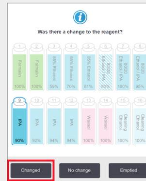
Selezionare il flacone sostituito toccandolo sullo schermo. Toccare **Changed (Sostituito)**.
