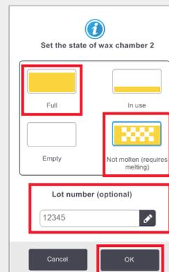
Régler l'état de la chambre sur **Full** (Pleine) (paraffine liquide) ou **Not molten** (Non liquide) (Parablocks ou granules).
