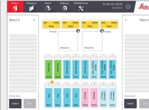
Remplacer les réactifs lorsque les flacons apparaissent hachurés sur l'écran **Status** (État).
