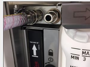
Connecter le tuyau de remplissage/purge à distance.
