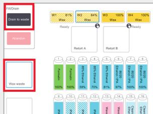
Aller à Reagents > Remote Fill/Drain (Réactifs > Remplissage/Purge à distance). Appuyer sur **Wax waste** (Déchets de paraffine) et sur les chambres de paraffine à purger, puis sur **Drain To Waste** (Vidanger les déchets).
