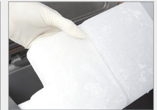
**ODER** geben Sie das Wachs direkt dem Bad hinzu. Verwenden Sie Parablocks für eine einfache Handhabung und schnelles Schmelzen.
