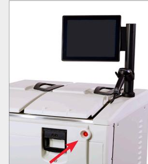
Warten Sie, bis der Bildschirm gelöscht ist, und drücken Sie dann auf den **Netzschalter** an der Vorderseite des Instruments.
