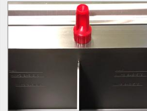
**Entweder** Verwenden Sie Paraplast (geschmolzen oder Pellets). Verwenden Sie den LLS-Tool-Wachsstopfen, um sicherzustellen, dass das Wachs nicht in den Wachsablass gelangt.
