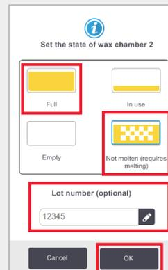
Stellen Sie den Kammerzustand auf **Full** (Voll, geschmolzenes Wachs) oder **Not molten** (Nicht geschmolzen, Parablocks oder Pellets).
