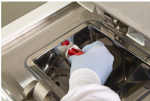
Protuberante da outra extremidade da ferramenta de limpeza do LLS existe um entalhe que pode ser introduzido no ventilador do banho de parafina. Isto ajuda a evitar a entrada de parafina no instrumento quando está a limpar em torno da superfície superior dos banhos de parafina.
