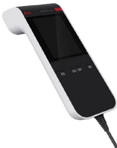
Das HistoCore I-Scan bietet 3 Hauptfunktionen, einen Barcode-Scanner, eine eingebaute Kamera und einen LCD-Bildschirm, der die von der Kamera aufgenommenen Bilder anzeigt. Der Scanner kann für die Ausführung der gleichen Funktionen wie ein herkömmlicher Barcode-Scanner verwendet werden, und die eingebaute Kamera wird für die Aufnahme von Bildern der mit Kassetten gefüllten Körbe verwendet.
