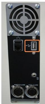
**Abbildung 2-19:** USB-Anschluss an der Vorderseite hinter einer Klappe
