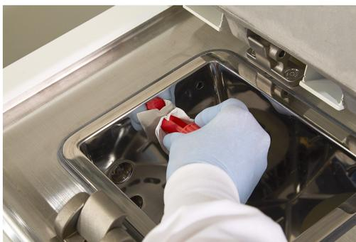
Aus dem anderen Ende des Reinigungswerkzeugs für Füllstandssensoren ragt ein Flansch heraus, der in die Entlüftung des Wachsbads eingeführt werden kann. Dadurch wird verhindert, dass Wachs in das Gerät fällt, wenn Sie um die Oberfläche des Wachsbads herum reinigen.
