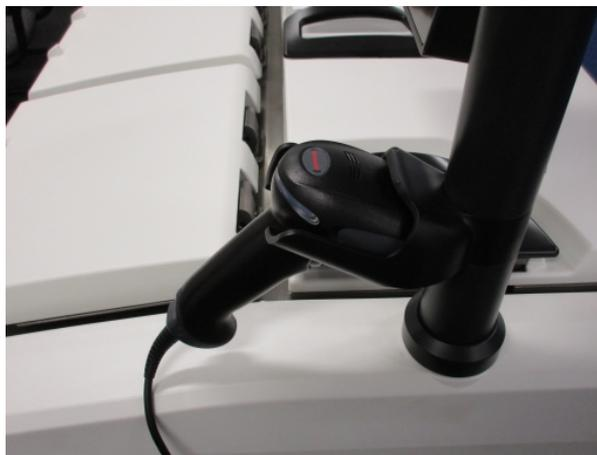
Der Scanner kann schnell verwendet werden, um Ihre Benutzer-ID, die ID auf dem Antireflexschild eines Korbs (siehe [2.2.4.4 Anti-Reflexionsschilder](#)) und der Chargen- oder Losnummer eines Reagenz einzugeben. Folgende Barcodeformate können gescannt werden:
