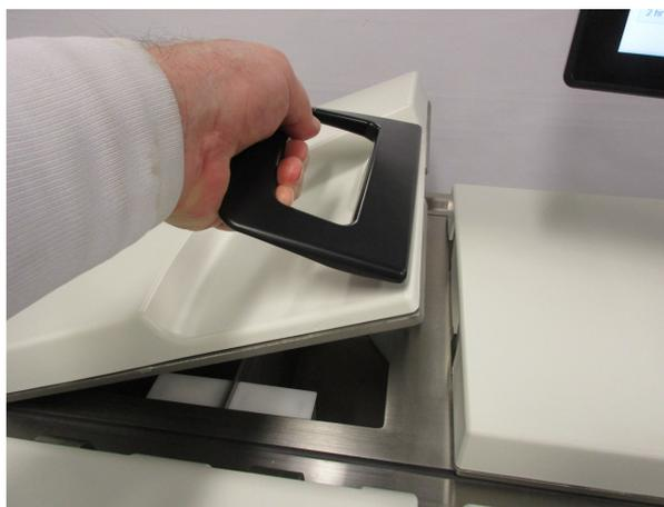
Stellen Sie vor dem Öffnen eines Deckels immer sicher, dass der Druck des Wachsbad dem Umgebungsdruck entspricht. Ist das Wachsbad nicht auf Umgebungsdruck, lüften Sie es zunächst. Sie können dies durch Anhalten des laufenden Programms oder über das Menü **Reagenzien > Manuelle Prozesse** erledigen. (siehe [6.1.1 Manuelle Prozesse](#).)
