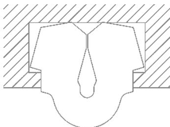
**Figure 7-15:** Section transversale du joint du bain de paraffine dans le couvercle
