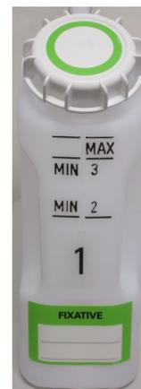
Pour retirer un flacon, tirez dessus. Repositionnez le flacon en le mettant à l'intérieur. Il s'insère dans son emplacement à l'arrière de l'armoire.
