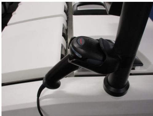
Le scanner peut être utilisé pour saisir rapidement votre ID utilisateur, l'ID sur une étiquette anti-reflet d'un panier (voir [2.2.4.4 Étiquettes anti-reflets](#)), et le lot ou un numéro de lot d'un réactif. L'appareil peut scanner les formats de codes-barres suivants :
