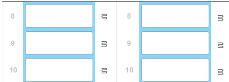
Una vez que esté apagada la calefacción del portaobjetos, debe apagar y luego reiniciar el módulo de procesado para eliminar el bloqueo del calentador. Puede continuar utilizando las posiciones de portaobjetos con calentadores averiados siempre y cuando los portaobjetos procesados en ellas no requieran calefacción.
