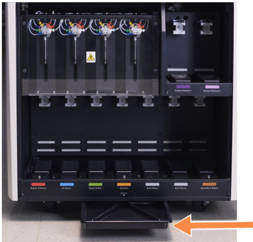
Utilice el procedimiento siguiente para acceder a la bandeja de goteo del instrumento:
