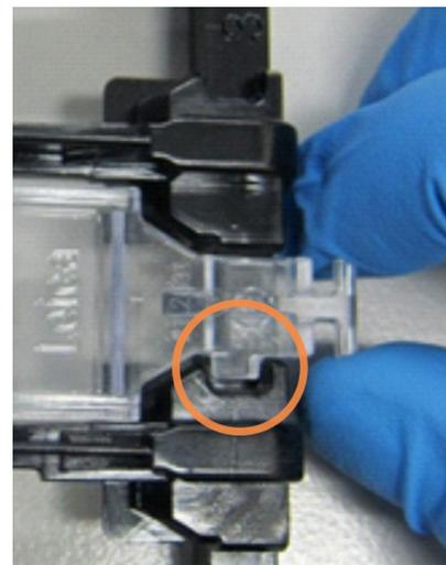
Hay dos diseños de Covertile que pueden utilizarse de manera intercambiable. El nuevo diseño incluye características (la palabra **Leica**, una pequeña marca circular y un saliente en la parte superior izquierda) que hacen que resulte más evidente cuando un Covertile se ha colocado de manera incorrecta sobre un portaobjetos.
