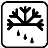
Schaltet die manuelle Kammerabtauung ein. Diese Taste (→ "Abb. 10-3") ist nur funktionsfähig, wenn zuvor eines der Menüelemente **SET TEMP CT ... °C** oder **SET TEMP OT ... °C** ausgewählt wurde (wobei Letzteres nur auf Geräten mit Objektkühlung verfügbar ist).
