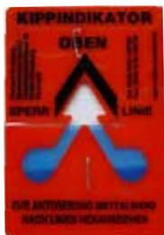
O indicador Tip-n-Tell monitora se a remessa foi transportada e armazenada na posição vertical, de acordo com suas demandas. Com um passo de  $60^{\circ}$  ou mais, a areia de quartzo azul flui na janela indicadora em forma de seta e permanece lá constantemente. O manuseio inadequado da remessa foi imediatamente detectado e pode ser facilmente provado.
