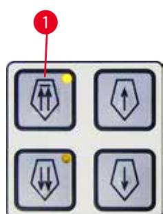
倍速电动粗进用于快速将样品移向和远离切片刀。
