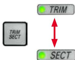
要在切片模式和修片模式之间切换，可按下 **TRIM/SECT**(修片/切片)按钮。每次按下按钮后，显示屏将在 **SECT**(切片)和 **TRIM**(修片)之间切换。
