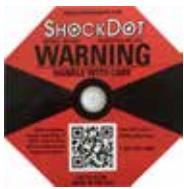
在 Shockwatch 系统中有个测震点，可以红色色调图显示超过指定强度的冲击或撞击。超过规定的加速(g值)将导致指示管改变颜色。
