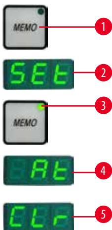
使用独立控制面板上的 **MEMO** (记忆) 按钮 ([→ "图 19-1"](#)) 设置一个记忆位置。如要设置一个记忆位置，将样本头移动到所需位置，然后按下 **MEMO** (记忆) 按钮。听到一声短信号音；三位显示屏指示 **SEt** ([→ "图 19-2"](#))；**MEMO** (记忆) 按钮的 LED ([→ "图 19-3"](#)) 亮起绿色。
