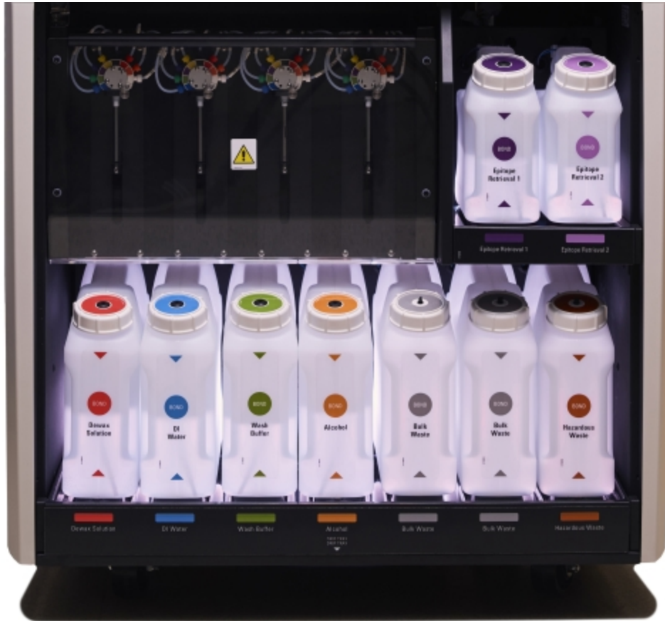
图 2-15:大容器照明系统
