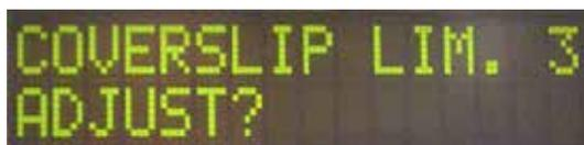
Die Einstellung des Parameters **LIM** legt fest, bei welcher Anzahl von verbliebenen Deckgläsern im Deckglasmagazin die Meldung **COVERSLIPS LOW** (WENIG DECKGLÄSER) angezeigt wird. Dadurch wird auf eine kritische (geringe), im Magazin verbleibende, Deckglasmenge aufmerksam gemacht.
