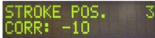
Die Auftragsposition des Eindeckmediums kann mit dem Parameter **STP** (→ Abb. 44-1) (Startpunkt des Eindeckmediumauftrags) verändert werden.
