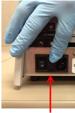
Cajón de fusibles
