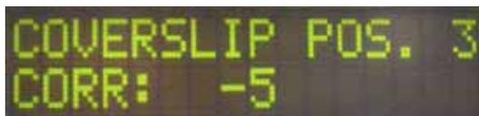
Позиция наложения покровного стекла может быть изменена с помощью параметра **CSP** (→ Рис. 43-1) (Позиция наложения покровного стекла) (→ Рис. 43).
