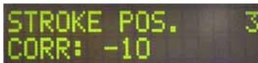
Начальное положение нанесения среды для заключения может изменяться при помощи параметра STP (→ Рис. 44-1) (Начальная точка нанесения среды для заключения).
