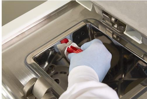
En el otro extremo de la herramienta de limpieza SNL, se encuentra una lengüeta que puede introducirse en la ranura de purga del baño de parafina. De este modo, evitará que caiga parafina en el instrumento al limpiar la superficie superior de los baños de parafina.
