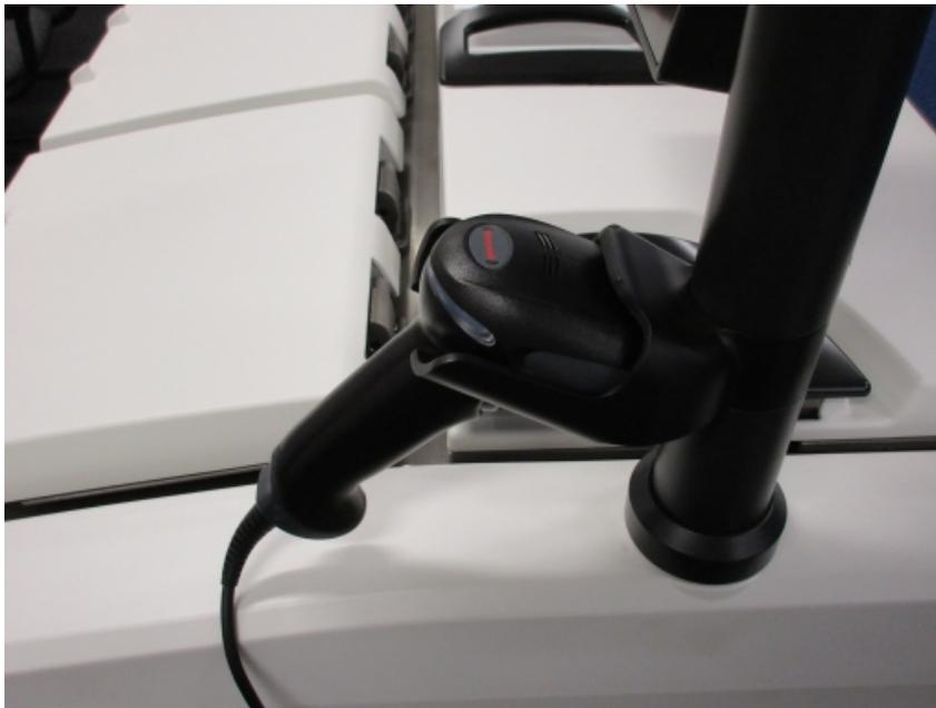
Con el escáner, puede ingresar fácilmente su identificación de usuario, la de la etiqueta antirreflejante de la cesta (consulte [2.2.4.4 - Etiquetas antirreflectantes](#)) o el número de lote de un reactivo. Puede escanear los siguientes formatos de código de barras:
