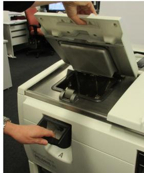
Sea siempre consciente del contenido, de la temperatura y de la presión de una retorta antes de abrirla. En determinados casos, puede que necesite establecer la presión y la temperatura de la retorta manualmente antes de poder abrirla con total seguridad (consulte [2.2.1.1 - Descargar la presión de una retorta](#)).
