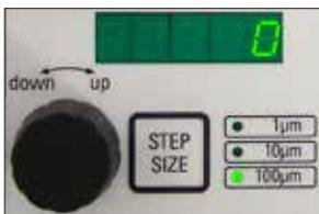
시료 용기를 수직으로 이동하기 위한 회전식 손잡이 2를 사용하면 블레이드와 시료 사이 거리를 미세 조정하고 원하는 절편 두께를 조정할 수 있습니다. 스텝 크기는 STEP SIZE 키를 눌러 1, 10 또는 100  $\mu\text{m}$  중에서 선택할 수 있습니다.
