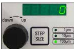
El botón giratorio 2 para el desplazamiento vertical del recipiente de la muestra sirve tanto para la aproximación de precisión entra la muestra y la cuchilla como para la selección de los espesores de corte deseados. Se puede seleccionar incrementos en pasos de 1, 10 o 100  $\mu\text{m}$  pulsando la tecla **STEP SIZE**.
