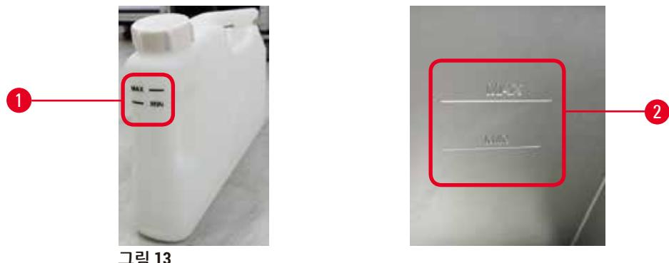
레토르트는 카세트 2개에 사용하기 충분한 시약으로 채울 수 있습니다. 시약 병(→ 그림 13-1) 및 파라핀 수조(→ 그림 13-2)의 표시를 보고 레토르트에 충분한 양의 시약을 채웠는지 확인할 수 있습니다. 시약과 파라핀은 항상 최소(MIN) 수위보다 충분히 많게 채워되 최대(MAX) 수위보다는 낮아야 합니다. 시약 수위가 최소 표시보다 낮으면 프로토콜이 실행되지 않거나 차선의 시약 시퀀스가 사용됩니다.
