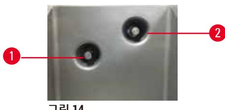
각 레토르트에는 유체 수위를 모니터링하기 위한 액체 수위 센서가 2개 있습니다. 아래쪽 센서(→ 그림 14-1)는 2개 바스켓 수위를 모니터링합니다. 위쪽 센서(→ 그림 14-2)는 레토르트에 최대량보다 많은 양의 액체가 유입되면 실행됩니다. 이 센서는 안전 기능을 담당합니다.
