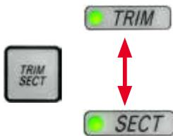
セクションニングモードとトリミングモードを切り替えるには、セパレート式コントロールパネルの **TRIM/SECT** ボタンを押します。ボタンを押すごとに、**SECT** と **TRIM** が交互に切り替わります。
