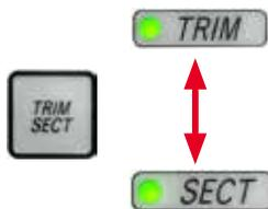
Para cambiar entre el modo de corte y el modo de recorte, pulse el botón **TRIM/SECT** en el panel de control independiente. Pulsando cualquier botón, la pantalla cambia entre **SECT** y **TRIM**.
