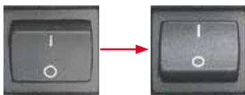
Encienda el instrumento con el interruptor de red situado en la parte posterior.
