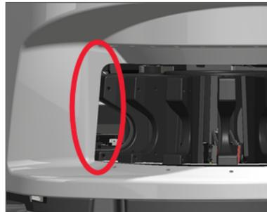
2. Stellen Sie sicher, dass sie Racks im Rack-Ladebereich korrekt eingelegt sind:
