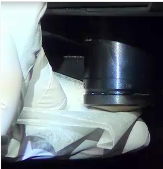
7. Verwenden Sie ein sauberes, fusselfreies Mikrofasertuch und die unter Schritt 6 beschriebene Technik, um die Köhler-Feldblende zu reinigen. Die Köhler-Feldblende befindet sich unterhalb des Objektivs, wie unten weiß eingekreist dargestellt.
