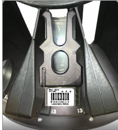
3. Wenn Sie das Rack einlegen, überprüfen Sie, ob die Rack-Position und das Rack-Statuslicht blau werden (warten auf Scan):
