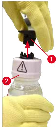
6. Vložte novú fľašu zalievacieho média (→ Obr. 58-1) do otvoru L2 v zásuvke (→ Obr. 58-2) na fľaše a uistite sa, či je čip RFID pripojený k fľaši je vložený do zárezu v otvore (→ Obr. 58-3).
