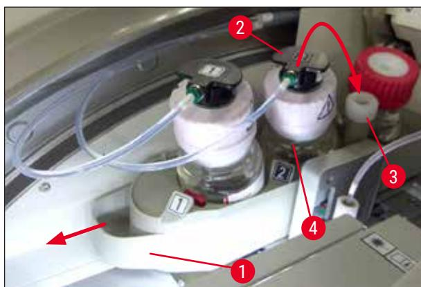
5. 新品の封入剤ボトル (→ 図57) を包装から取り出し、黒の樹脂製キャップ (→ 図57-1) を外します。
