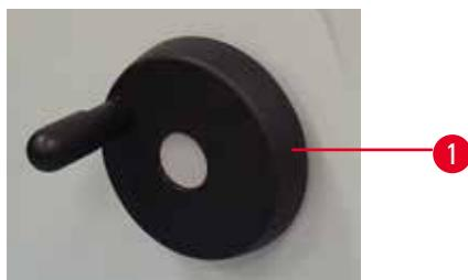
코스 이송 휠(→ "그림 12-1")의 방향을 시계 방향 또는 시계 반대 방향으로 돌려서 표본 고정 헤드를 이동할 수 있습니다. 제품의 후면 플레이트에 조정 슬롯(→ "그림 12-2")이 있습니다. 배송 시 제공되는 일자형 스크류 드라이버를 이용해 이 슬롯이 수평 상태가 되도록 시계 방향(→ "그림 12-3")으로 돌리거나 수직 방향이 되도록 시계 반대 방향(→ "그림 12-4")으로 돌리십시오.
