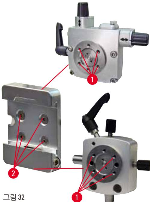
퀵클램핑 장치는 영점 표시기가 있는 시편 클램프용 미세 방향 조절형 고정 장치 또는 시편 클램프용 방향 조절형 고정 장치와 함께 사용하는 어댑터입니다. 2.5번 육각 키를 이용해 스크류 4개(→ "그림 32-2")를 보어(→ "그림 32-1")에 넣어서 조이십시오.
