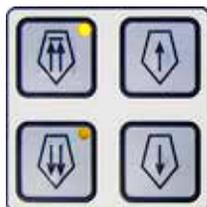
O avanço elétrico em duas velocidades é usado para obter rápido movimento da amostra para perto e para longe da faca.
