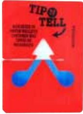
Indicador Tip-n-Tell para monitorar se o pacote foi transportado e armazenado na posição vertical de acordo com suas especificações. Com um passo de 60° ou mais, a areia de quartzo azul flui na janela indicadora em forma de seta e permanece lá constantemente. O manuseio incorreto do pacote é imediatamente detectável e pode ser comprovado definitivamente.
