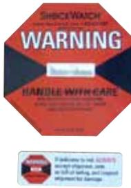
No sistema Shockwatch, um canhão de vidro de precisão fica vermelho se os choques ou impactos sofridos que superam a intensidade especificada. Exceder uma aceleração definida (valor g) destrói a tensão da superfície do líquido no interior do canhão. Isto faz com que o canhão indicador mude de cor.
