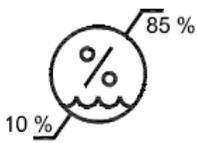
Indica a faixa de umidade permitida para armazenamento e transporte do pacote.
