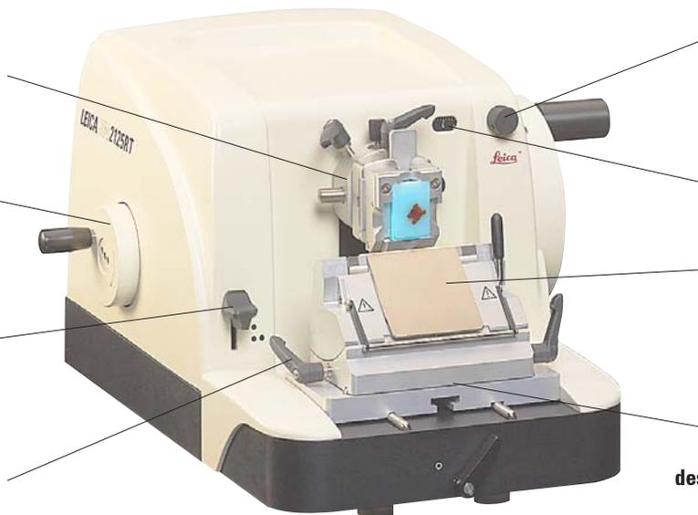
Botão de controle para ajuste de espessura de cortes
