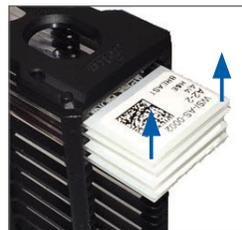
3. Introduzca las preparaciones en el rack presionando hacia dentro hasta que toquen la parte trasera de este.
