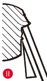
**图 II:** 切片后切片撕裂且样品块碰撞玻璃插件。
