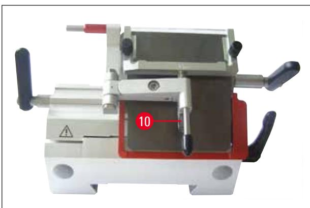
(→ 图 58)，带玻璃防卷板的 CE 型刀架
