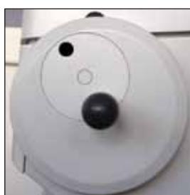
Вытяните ручку маховика наружу и установите в центре маховика. Ручка автоматически зафиксируется в данном положении.
