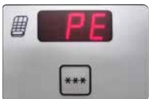
• 펠티어 요소는 냉각 스테이션에 추가적인 냉각을 제공합니다. 버튼을 누른 후에 디스플레이가 “PE”에서 “10”으로 바뀌면서 10분의 추가 냉각 시간을 알립니다. 남은 냉각 시간의 카운트다운이 계속 표시됩니다. 4분밖에 남지 않았으면 “4” 다음에 점이 표시됩니다. 이때 버튼을 다시 누르면 펠티어 요소를 조기에 끌 수도 있습니다.
