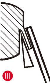
**図 III:** ナイフに対し適切なアンチロールガイドの位置
