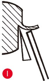
**図 I:** 切片がアンチロールガイドシステムのガラスインサートの上方でロールする。
