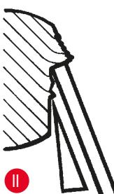
**Фиг. II:** Срезът се разкъсва и блок удря стъклена вложка след разрязването.
