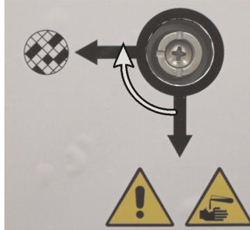
3. Se necessário, desligue o sistema externo da saída de vapor (consulte o item 2 na [Figura 2-18](#)). Pode deixar o sistema externo ligado enquanto a válvula de vapor isola eficazmente esta saída.
