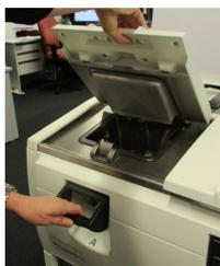
Avant d'ouvrir une chambre de réaction, pensez toujours à ce qu'elle contient, sa température et sa pression. Dans certains cas, vous devrez régler manuellement la pression et la température de la étuve avant de l'ouvrir en toute sécurité (voir [2.2.1.1 - Ventilation d'une chambre de réaction](#)).
