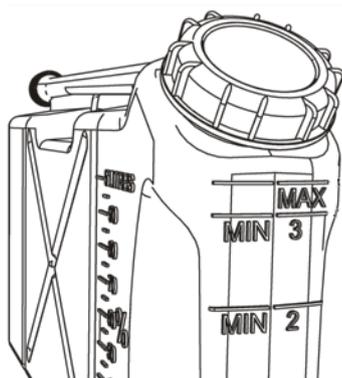
Figure 2-5: Niveaux de remplissage des chambres de paraffine
