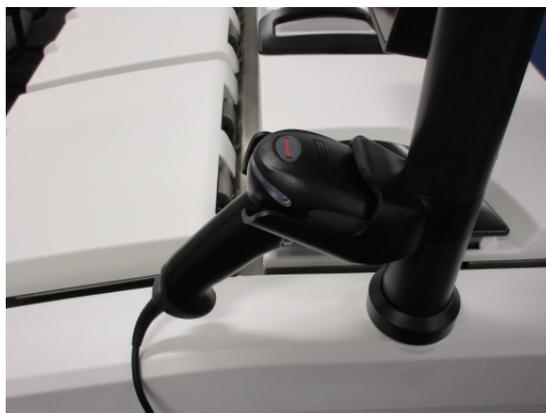
Le scanner peut être utilisé pour saisir rapidement votre ID utilisateur, l'ID sur une étiquette anti-reflet d'un panier (décrite [2.2.4.4 - Étiquettes anti-reflets](#)), et le lot ou un numéro de lot d'un réactif. L'appareil peut scanner les formats de codes-barres suivants :
