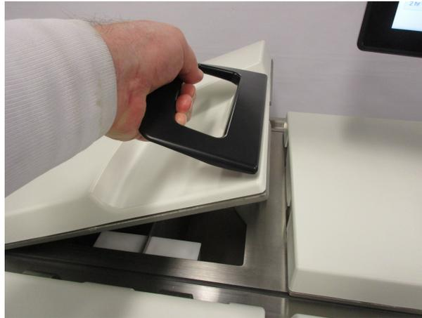
開啟蓋子前，請務必確保蠟槽壓力等於環境壓力。若與環境壓力不同，首先要讓蠟槽排氣。此時，您可以暫停執行處理方案，或在「**試劑**」>「**手動操作**」畫面操作。(請參閱「[6.1.1 - 手動操作](#)」。)
