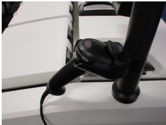
您可使用掃描器快速輸入您的使用者 ID、籃子上抗反射標籤上的 ID (如 [2.2.4.4 - 抗反射標籤](#) 所述), 以及試劑的批號。掃描器可掃描以下條碼格式:
