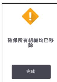
圖 3-1:移除蒸餾瓶中的所有組織之前，請勿輕點「完成」。
