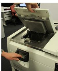
開啟蒸餾瓶蓋子前，一定要清楚蒸餾瓶的內容物、溫度及壓力。有時，在安全開啟前可能需要手動設定蒸餾瓶的壓力和溫度 (請參閱的[「2.2.1.1 - 讓蒸餾瓶排氣」](#))。
