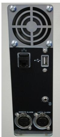
圖 2-17: 前 USB 連接埠, 封蓋後面
