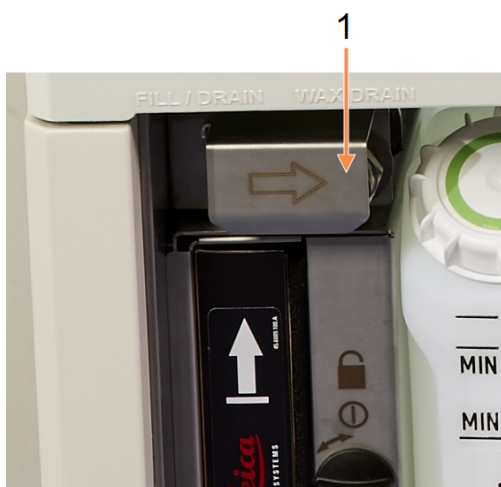
图 5-11:外接式加注/排放滑盖打开及试剂管(左)和废石蜡管道(右)
