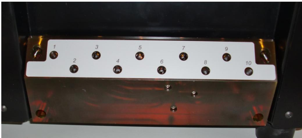
Figure 4-3: Orifices à réactif
