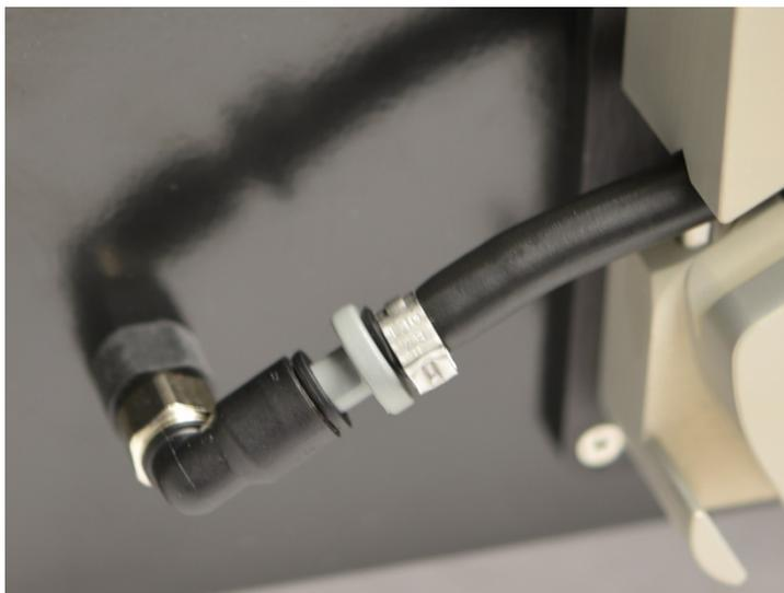
Figure 7-11: Insérer le bouchon dans l'orifice de sortie et d'entrée
