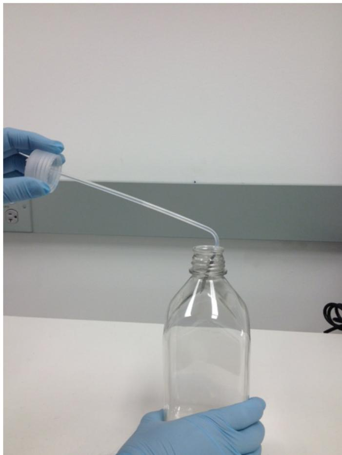
Figure 5-2: Retrait des bouchons et filtres des bouteilles de réactif
