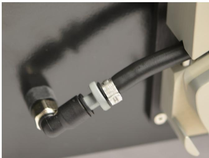
Figure 7-10: Retirer le bouchon sur l'orifice de sortie
