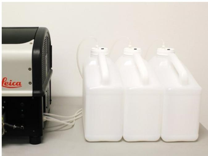
Figure 3-14: Positionnement des bouteilles de déchets – Niveau de surface
