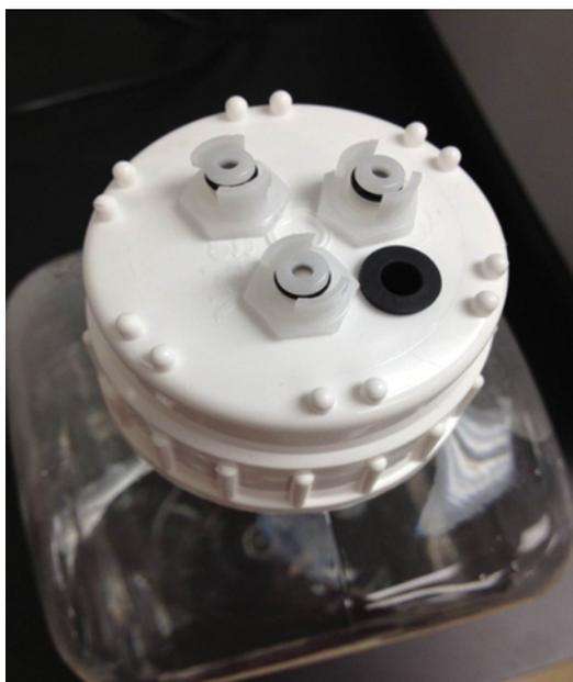
Figure 7-1: Insérer les raccords de tubulure de réactif sur la bouteille de lavage
