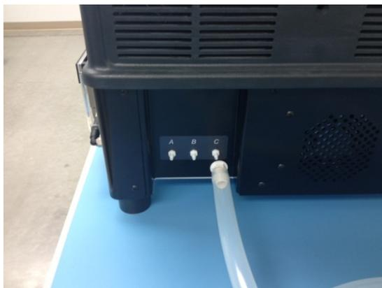
Figure 3-16: Raccordez le tube à déchets de secours sur l'orifice à déchets de secours
