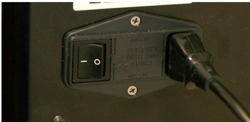
Figure 7-13: Interrupteur d'alimentation – Boîte à fusibles
