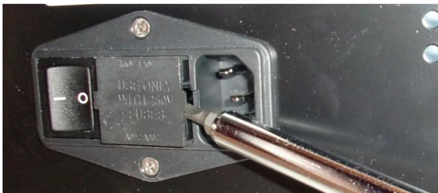
Figure 7-14: Interrupteur d'alimentation – Accéder au porte-fusibles
